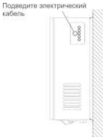
Рис.8. Расположение панели вывода электрического кабеля
